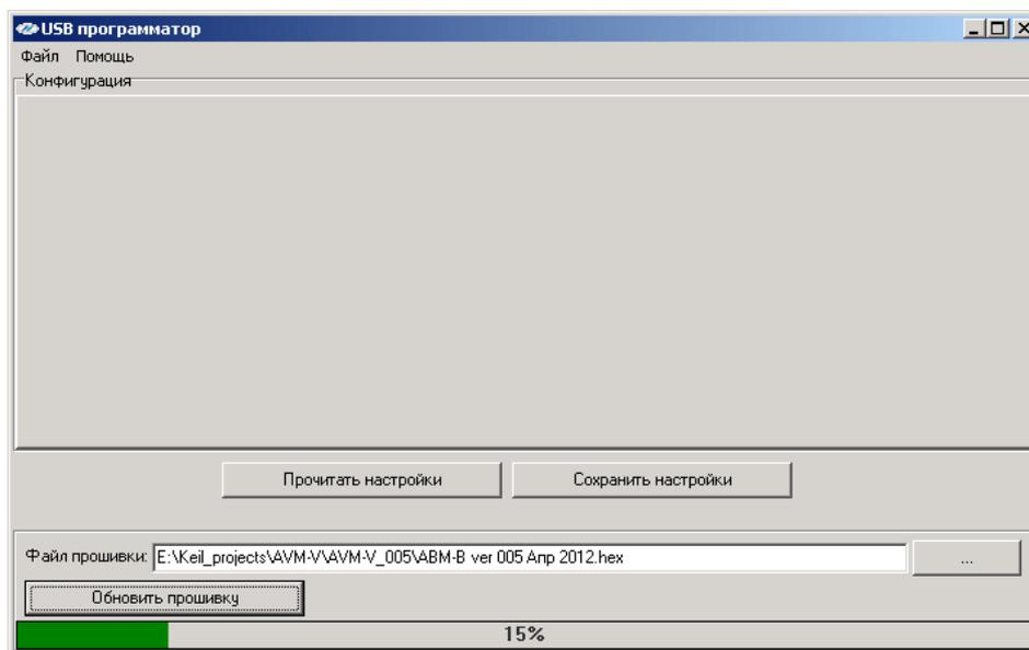
Процесс прошивки будет сопровождаться миганием индикаторов “включен” и “Отключен” на приборе. Дождитесь завершения процесса прошивки.
