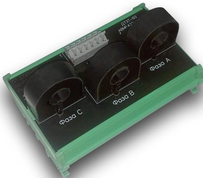
Рис. 2 – Преобразователь ДТЗТ-03
